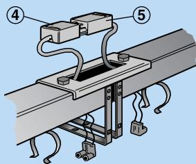
Principe d'assemblage en X Y /
